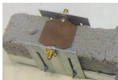
Figure 2 : cellule de test chargée avec de la ouate de cellulose.
